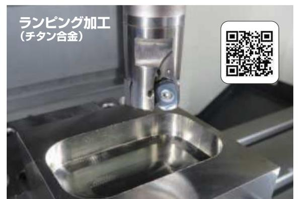
Vc=50m/min, ae=12.5mm (ae/DCX=50%), ランピング角度3°
